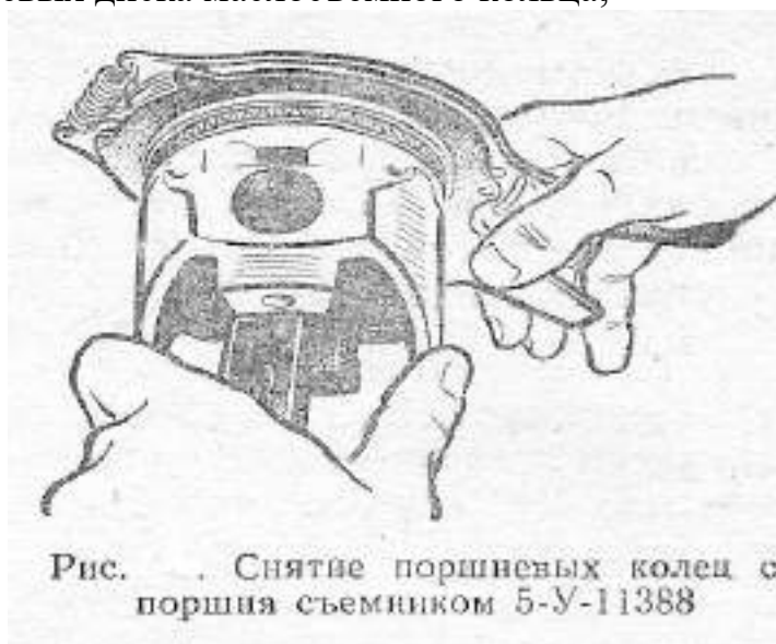
Рис.1.5. Снятие поршневых колец с поршня съемником 5-у-11388
