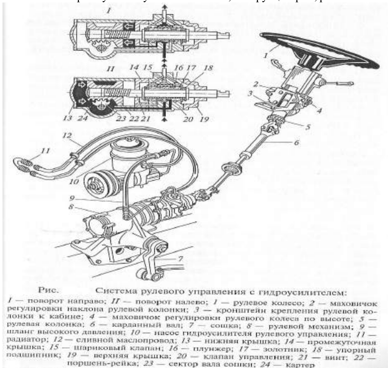
Рис.10.1. Система рулевого управления с гидроусилителем:
